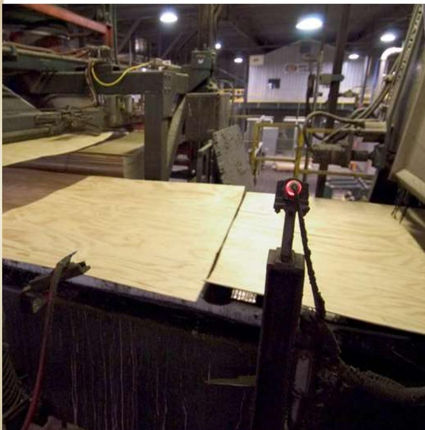
Los paneles con una clasificación superior se lijan. En esta etapa puede ser posible aserrar los bordes tipo “Machihembrado” o “Traslapado” (Shiplap).
