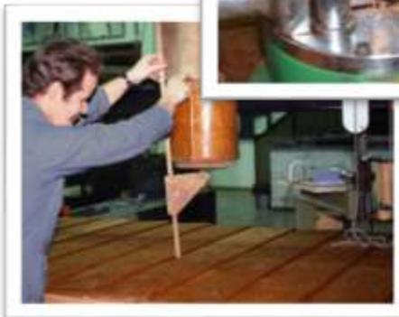
En las pruebas se evalúan características tales como resistencia, rigidez, durabilidad de la unión y estabilidad dimensional.
