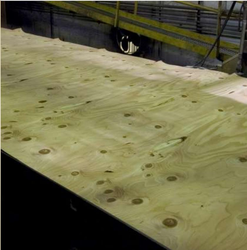
En la fabricación de madera contrachapada se utilizan tornos para separar la chapa de los troncos saturados de agua en distintos espesores.
