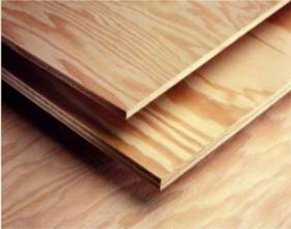
Los Paneles Lijados tienen una o más superficies clasificadas como chapa A, B o C- Parche. Las chapas A y B se lijan en fino. A las chapas tipo C- Parche se les da un acabado de lijado de retoque, lo que significa que pueden tener algunas irregularidades en la textura de la superficie.
