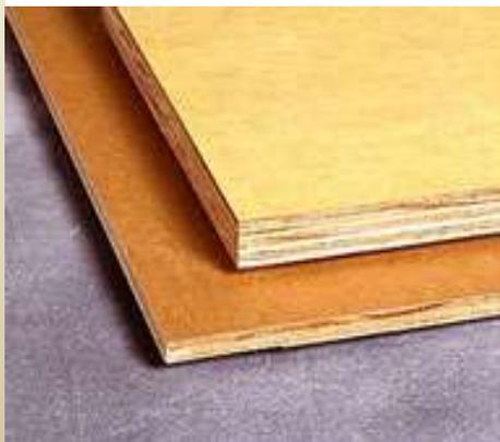
Existen dos tipos de revestimientos de papel saturado de resina: Revestimientos de Densidad Media (MDO) y Revestimientos de Alta Densidad (HDO). Los revestimientos tipo HDO tienen un mayor contenido de resina haciendo que la superficie sea más impermeable y dura.
